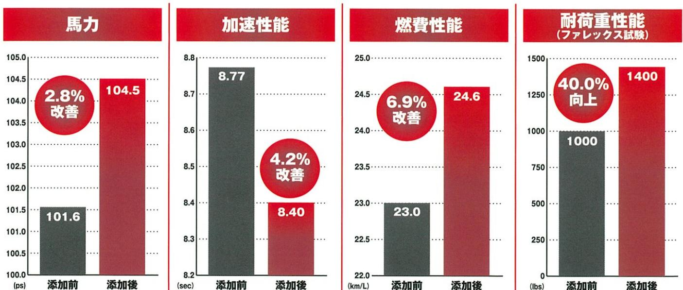
※馬力、加速性能、燃費性能は、2010年式S社1,500cc乗用車(走行66,121km)でシャシーダイナモにて測定。 ※加速性能はエンジン3,000回転から6,000回転までの所要時間を測定。 ※燃費性能は速度60km/hで10,000m走行した間の平均燃費を測定。 ※ファレックス試験はカーメーカー純正エンジンオイル0W-20 SNを使用しました。 ※車種やお車の状態、使用状況によって効果は異なります。
